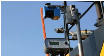
1 сурет - Асфальттөсегішке орнатылған RSS сканерлеу жүйесі
