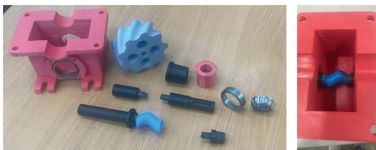
Рис. 12. Детали редуктора Fig. 12. Gearbox components
