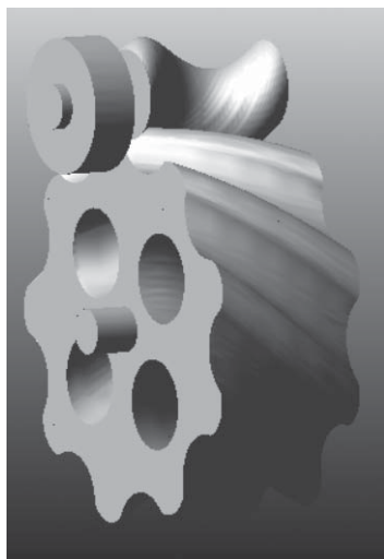
Рис. 6. Пространственная модель эксцентрика и циклоидальной шестерни в составе ЭЦ-передачи
