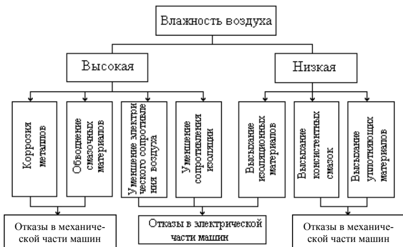
Рис. 10. Схема влияния влажности воздуха на процессы в материалах и надежность машин
