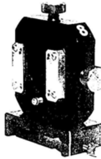
Рис. 12.9. Модуль 8 – кассета для установки экранов
