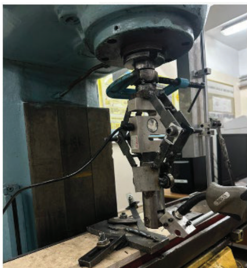
1-сурет – Дәнекерлеумен бірге жүргізілетін илемдеу жүйесінің құрылымы және оның тәжірибедегі қолданылуы: а – жүйенің жұмыс принципін көрсететін схемалық бейне; ә – зертханада қолданылған нақты эксперименттік қондырғының фотосуреті.
