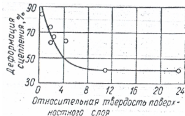
Рис. 5. Зависимость деформации сцепления различных металлов с прокладками из фольги от относительной твердости фольги [22]
