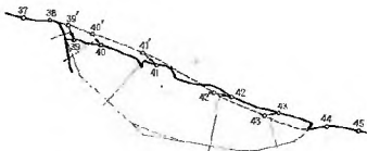
Рис. 28. Определение положения поверхности скольжения по данным наблюдений за смещением реперов
