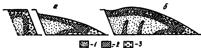
Рис. 24. Распределение зон дробления при однорядном (а) и многорядном КЗВ (б). Зоны дробления: 1 — мелкого, 2 — среднего, 3 — крупного
