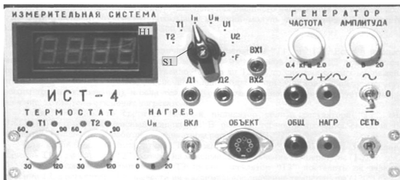
3-сурет. ИСТ–4 өлшеу жүйесінің алдыңғы панелі
