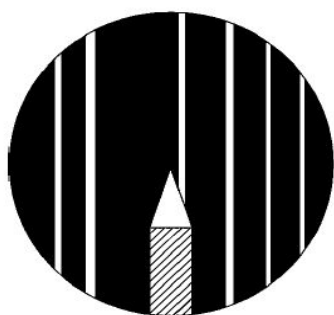
Рис. 8.5. Вид поля зрения окуляра с набором спектральных линий и иглой-указателем
