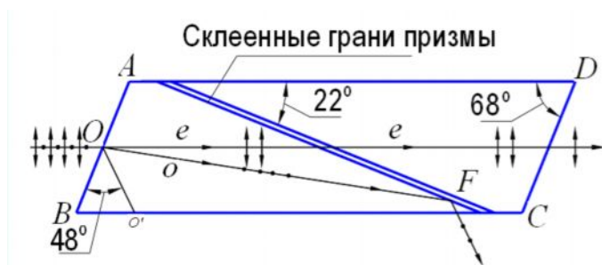
Рис. 5.6. Ход линейно поляризованных лучей света в призме Николя
