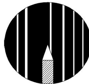
Рис. 7.6. Вид поля зрения окуляра с набором спектральных линий и иглой-указателем
