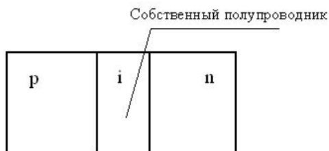
Рис. 2.7. СВЧ-диод pin – структуры без внешнего напряжения
