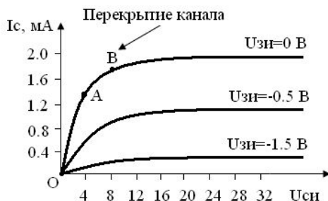
Рис. 4.7. Выходные характеристики полевого транзистора с управляющим pn -переходом
