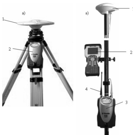
40-сурет. Trimble R7 GNSS жүйесінің технологиясы: а) – Базалық станция: 1-антенна; 2-қабылдағыш. ә) – Далалық ровер: 1-антенна; 2-контроллер; 3-қабылдағыш; 4-радиомодем антеннасы.
