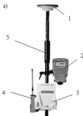
44-сурет. а) Штативке орнатылған базалық станция: 1-антенна; 2-трегер; 3 - радиомодем; 4 - контроллер; 5-қабылдағыш (GPS1230); ә) Қадаға орнатылған далалық ровер: 1-антенна; 2-контроллер; 3 -қабылдағыш; 4- радиомодем; 5-қада
