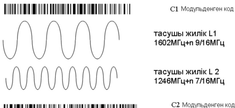
8-сурет. ГЛОНАСС жер серігі сигналдарының құрылымы
