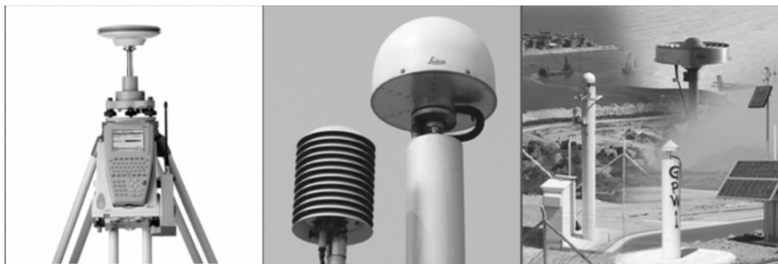
28-сурет. Базалық станцияға арналған GPS антенналары: локальды (уақытша) базалық станция; Тұрақты жеке базалық станция; тұрақты базалық станция желісі
