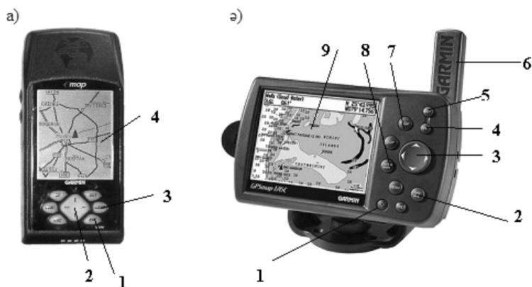
49-сурет. Жерсеріктік Garmin навигаторлары: а) 1 - растау пернесі; 2 - маршрутты бағыттау; 3 - меню; 4 - бір түсті дисплей және маршрутты көрсету көрінісі; ә) GPSMAP 176C: 1- іске қосу және жарықтандыру пернесі; 2 - навигациялау пернесі; 3 - маршрутты бағыттау; 4 - дисплейдегі көріністі жақындату; 5 - дисплейдегі көріністі алыстату; 6 - антенна; 7 - көрініс беттерін парақтау; 8 - функцияны растау; 9 - дисплей және ондағы карта көрінісі
