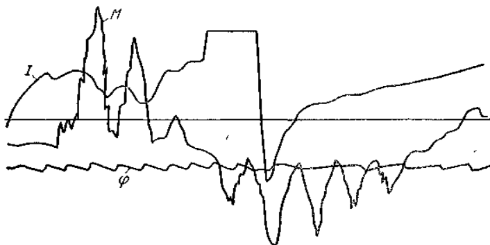
21-сурет. Ұзын тұмсықты тербету механизмінің жүктеме оциллограммасы
