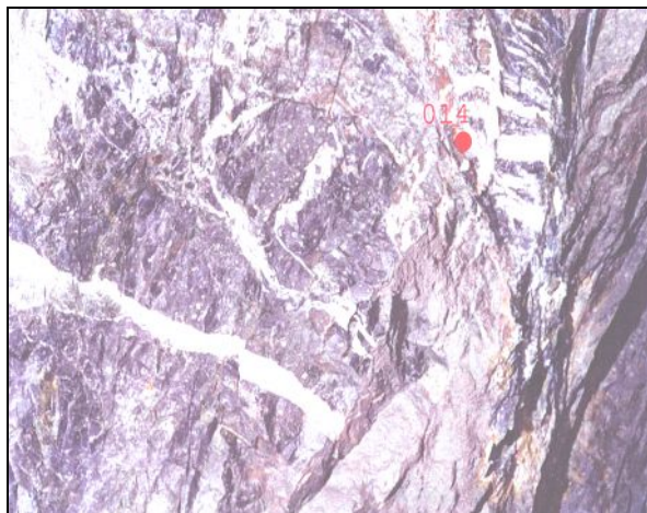
Рис. 5. Кварц-сульфидные прожилки в катаклазированных микрокварцитах (кровля орта 27, гор. 15, Южный фланг Быструшинской залежи)
