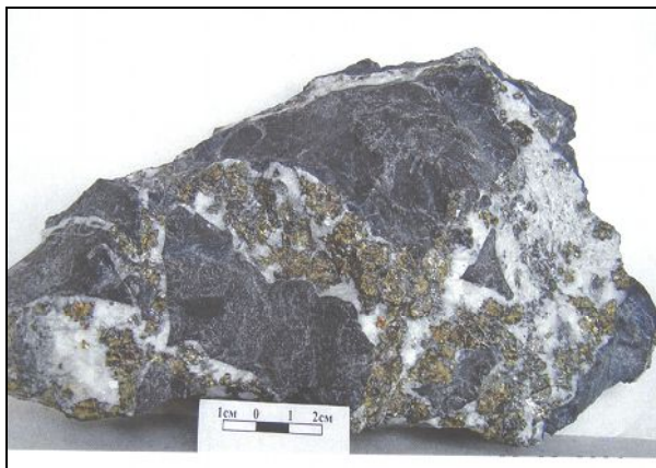
Рис. 7. Кварц-полиметаллическая руда цементирует обломки микрокварцитов (гор. 15, Южный фланг Быструшинской залежи)
