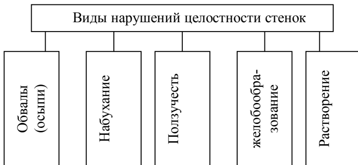
Рис. 1.1. Классификация нарушений целостности стенок скважины (по Ю.В. Вадецкому)
