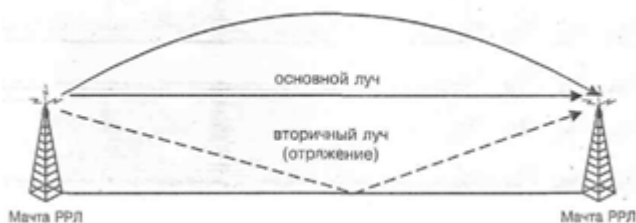
Рис. 6.6. Явление многолучевого прохождения сигнала в РРЛ
