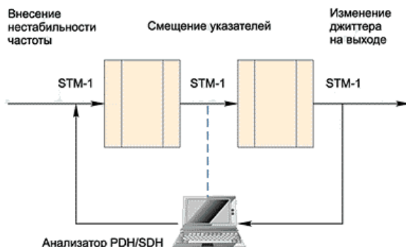
Рис. 8.2. Контроль компенсации рассинхронизации в сети
