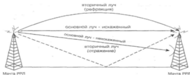
Рис. 6.7. Резервирование антенных устройств приемника для поиска наилучшего пути распространения сигнала
