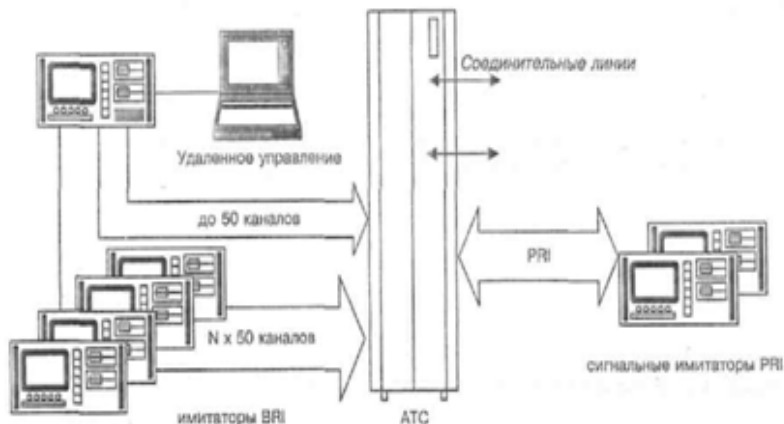
Рис. 9.5. Схема совместного использования имитаторов базового и первичного доступа в сети ISDN
