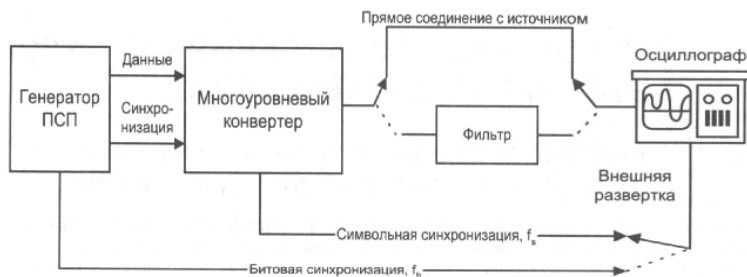
Рис. 8.6. Структурная схема измерения глазковой диаграммы
