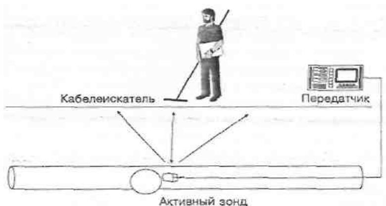
Рис. 4.2. Схема определения препятствия для прокладки кабеля в трубе
