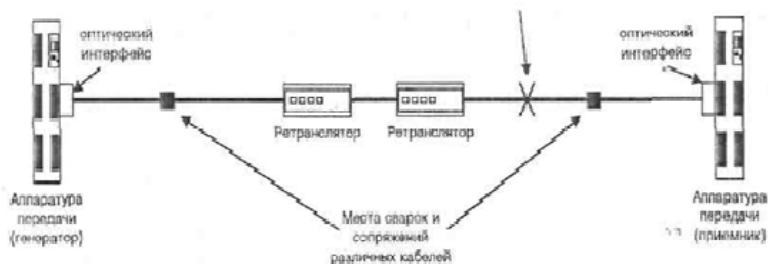
Рис. 3.1. Типовая схема волоконно-оптической линии связи
