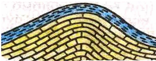
Рис.12. Массивный однородный резервуар
