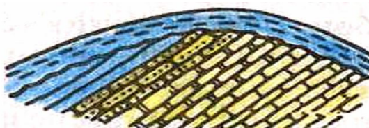
Рис. 13. Массивный неоднородный резервуар
