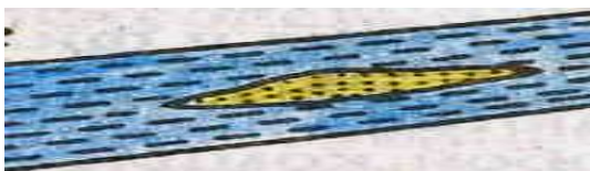
Рис. 14. Литологически ограниченный резервуар
