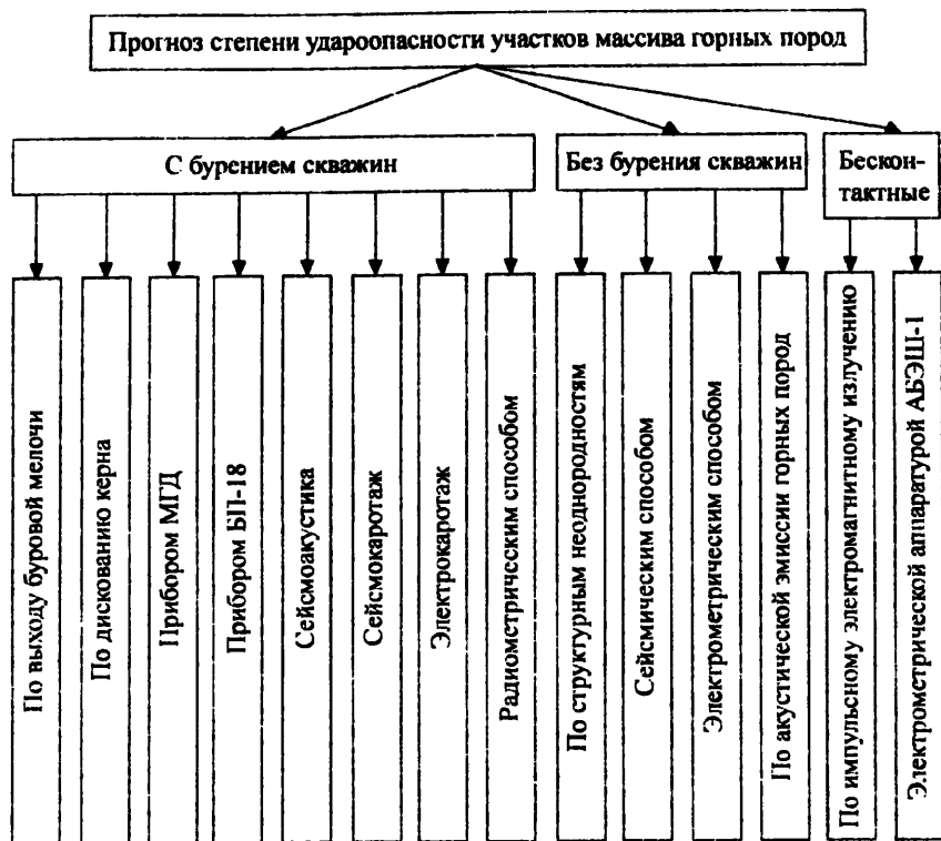
Рис. 1.7. Способы прогноза степени удароопасности участков массива горных пород
