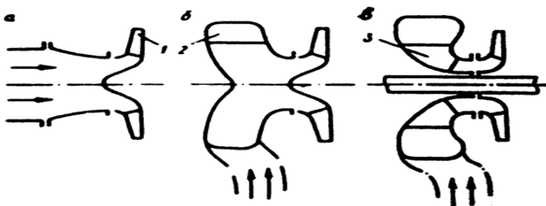
2.6-сурет. Айдағыштардың кірерліктегі келте құбырларының құрылымдық сұлбасы;
