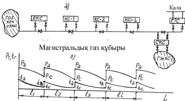
1.7-сурет. Магистральды – газ құбырындағы қысым мен температуралардың өзгеру сұлбасы
