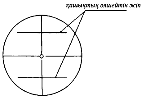
3.9-сурет. Көру дүрбісінің ішкі көрінісі – жіптік тор
