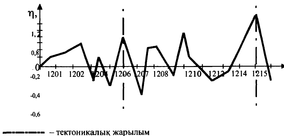
9.14-сурет. «Теңіз» ГДП реперлерінің шөгү графигі
