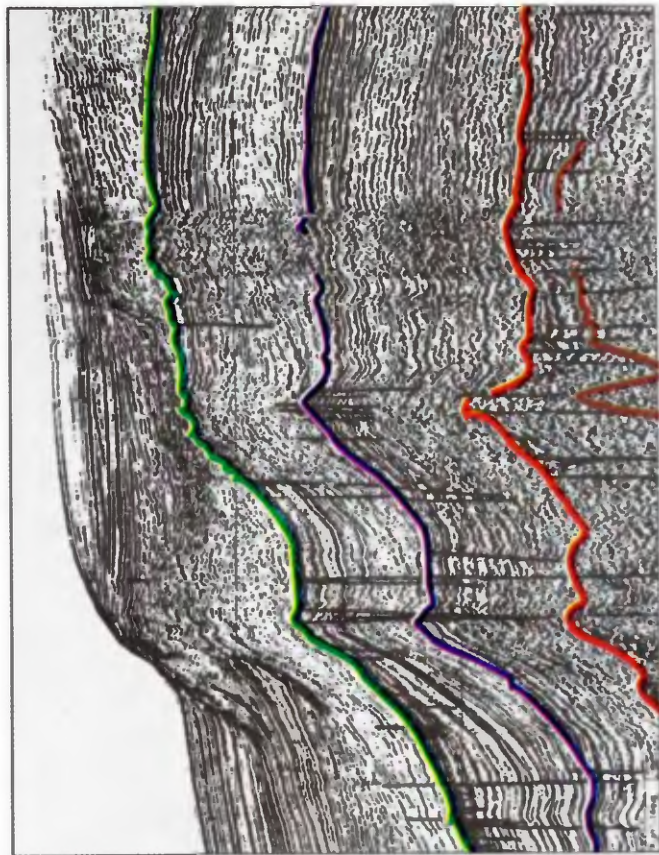
Рис. 36. Строение палеогеновых и неогеновых отложений в зоне перехода Мангышлакской системы дислокации в Южно-Мангышлакский прогиб (фрагмент профиля KCS)
