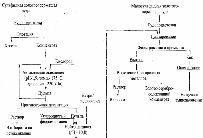
Рис. 3.94. Технологическая схема совместной переработки сульфидных и малосульфидных руд
