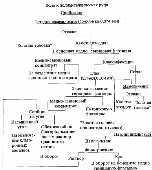
Рис. 3.104. Технологическая схема переработки золотополиметаллической руды
