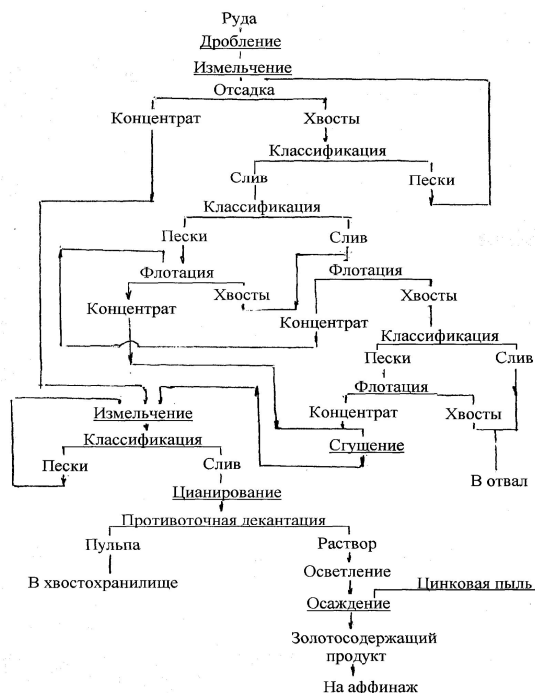
Рис. 3.97. Технологическая схема переработки золотосодержащей руды с цианированием гравитационного и флотационного концентратов
