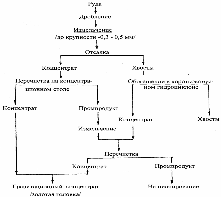
Рис. 3.54. Технологическая схема выделения свободного золота в цикле измельчения
