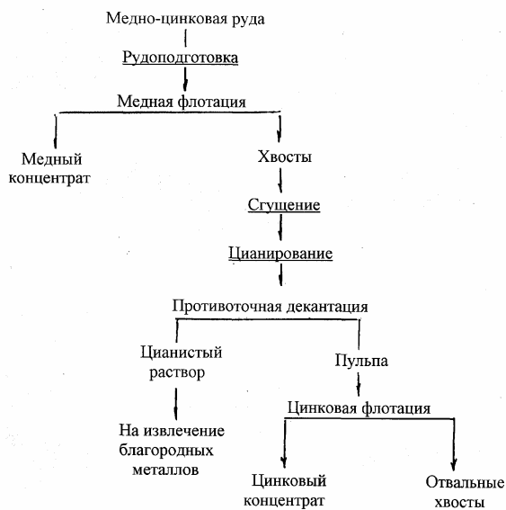
Рис. 3.91. Технологическая схема переработки медно-цинковых руд с операцией цианирования
