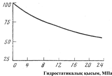
68-сурет. Бұрғылау жылдамдығының гидростатикалық қысымға тәуелділігі
