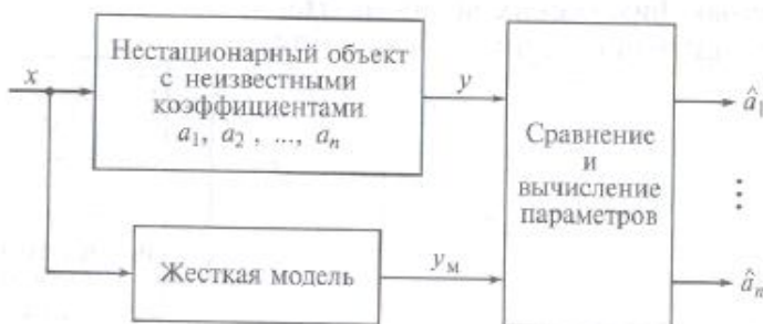
Рис. 7. Идентификация объекта с помощью жесткой модели
