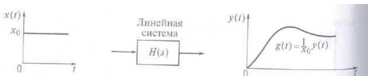
Рис. 3. К определению переходной функции системы
