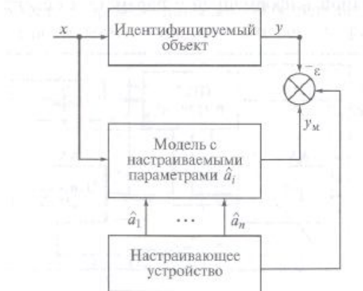
Рис. 9. Идентификация с помощью самонастраивающейся модели
