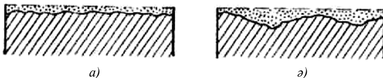
1-сурет. Металдың жалпы тегіс (а) және тегіс емес (ә) коррозиясы
